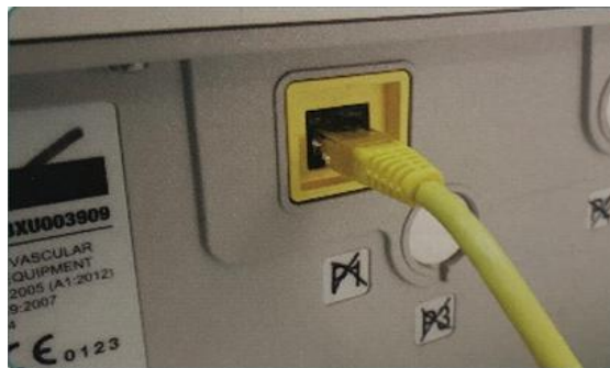
圖 1.4 網路線另一端連接至全自動腹膜透析機的背部黃色接孔
