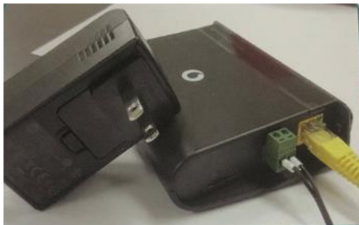
圖 1.3 將變壓器及網路線連接至數據機
