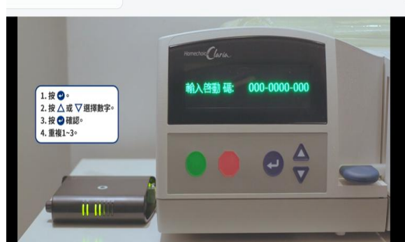
圖 1.5 將變壓器接上電源，等待約 1 分鐘，訊號源至少出現 1 格，開啟全自動腹膜透析機(訊號源出現綠燈，才能開啟)
